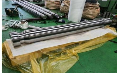
切削と鍛造を組み合わせることで、材料の**スクラップロス抑制**や**加工量削減**に繋がる
