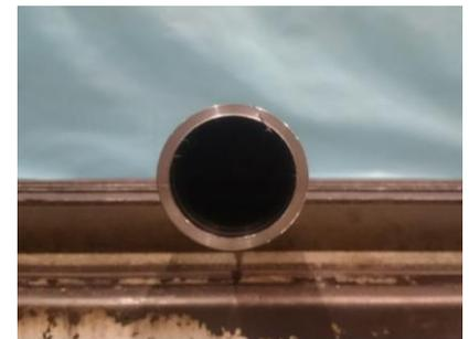
丸棒の規格に近い**パイプ**からの**穴あけ加工**により、**穴あけ加工量削減**となる
