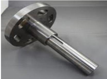
同材質異径材の**摩擦圧接**をすることにより、削出しと比較して**加工量削減**となる
